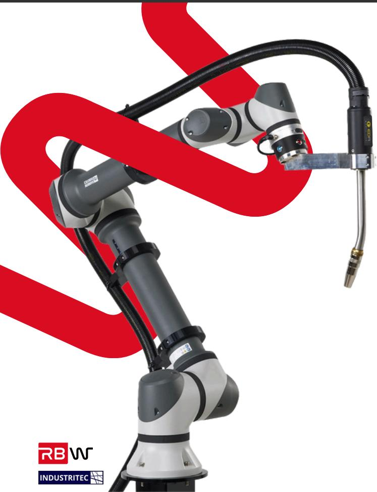
El RB-MIG es un sistema líder en soldadura MIG, diseñado para fabricantes, reconocido por su facilidad de uso.
