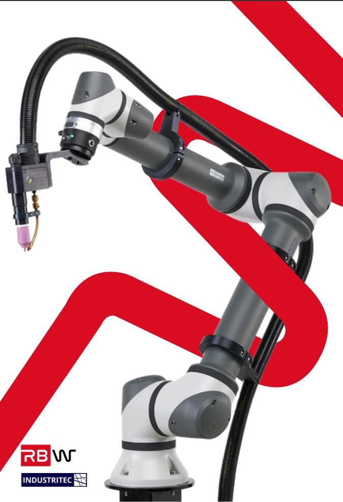
Soldadura TIG colaborativa, bien hecha. RB-TIG está diseñado para fabricantes que buscan automatizar la soldadura TIG de forma intuitiva.
